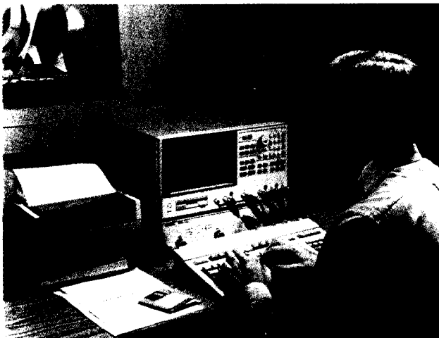
Abbildung 1: Integration verschiedener Meßgeräte zu einem Testsystem durch den HP 4396A Option 1C2.
