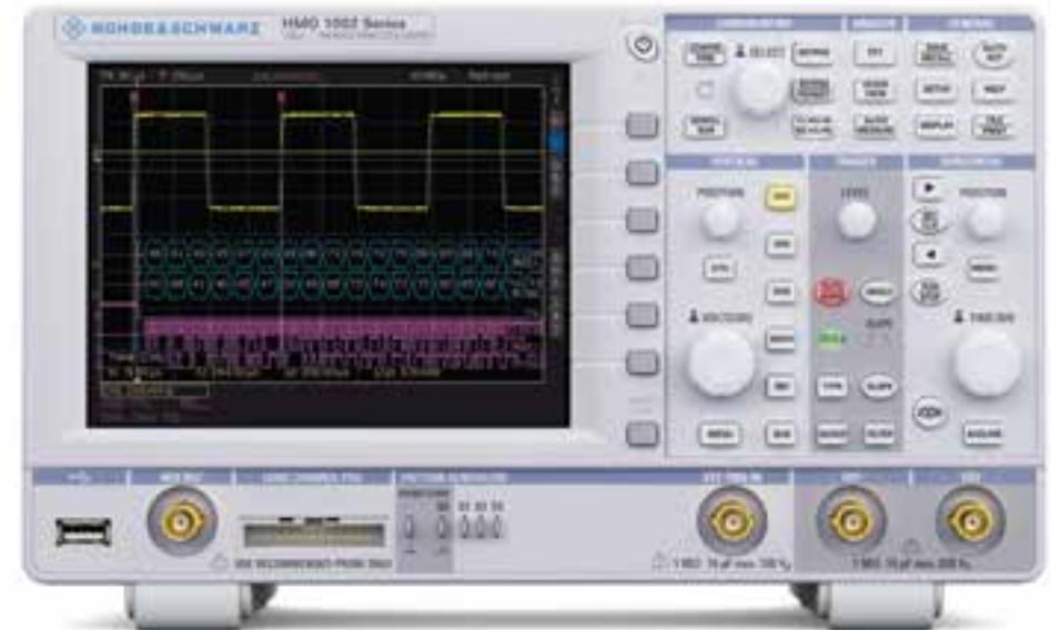
technikern die Arbeit. So lassen sich mit der R&S®HMO1002 oder R&S®HMO1202 Serie Spannungsmessungen auf beiden Analogkanälen mit jeweils zwei Messwerten gleichzeitig durchführen.
