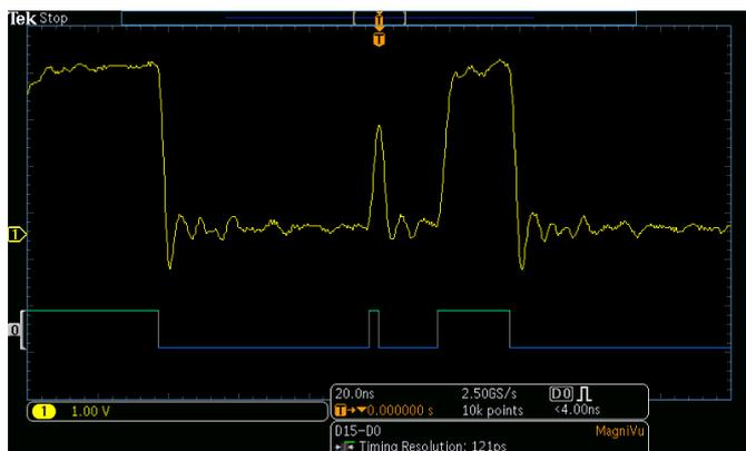
Die hochauflösende MagniVu-Aufzeichnung bietet eine Zeitauflösung von 121,2 ps und ermöglicht dadurch kritische Timing-Messungen an den digitalen Signalen.
