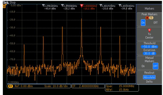
Automatisierte Peak-Marker kennzeichnen wichtige Informationen, sodass sie auf einen Blick erkennbar sind. Wie hier dargestellt, werden die fünf größten Amplituden-Peaks, welche die Schwellwert- und Abweichungskriterien erfüllen, zusammen mit der Peak-Frequenz und -amplitude automatisch markiert.
