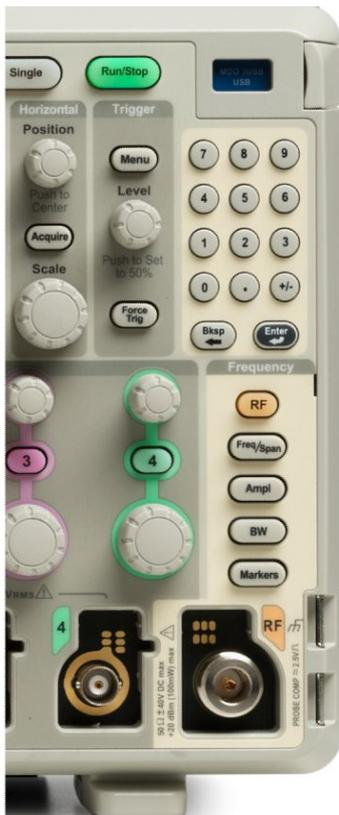
Spezielle Menüs und Tasten auf dem Frontpaneel ermöglichen die schnelle Einstellung von wichtigen Spektralparametern.
