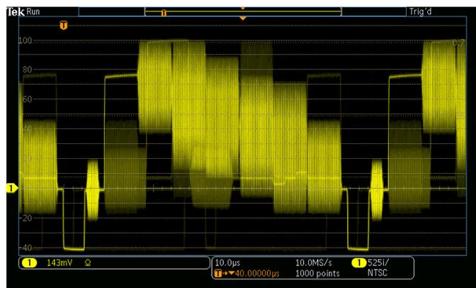
Anzeigen von NTSC-Videosignalen. Beachten Sie die hellkeitsmodulierte Darstellung, die durch die Fähigkeit des MDO3000 ermöglicht wird, Zeit, Amplitude und Verteilung im Zeitverlauf darzustellen.
