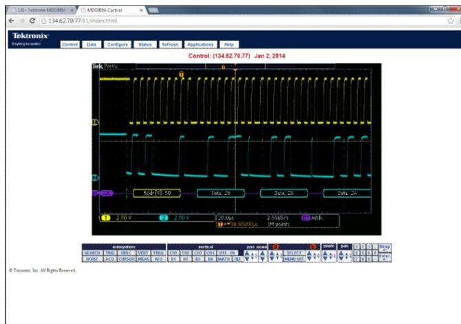
e\*Scope in einem Webbrowser, der die Anzeige eines MDO3000 zeigt. Mit e\*Scope können Sie Ihre Arbeit schnell dokumentieren, indem Sie Bildschirmdarstellungen, Signale oder Einstellungen zur späteren Verwendung speichern.
