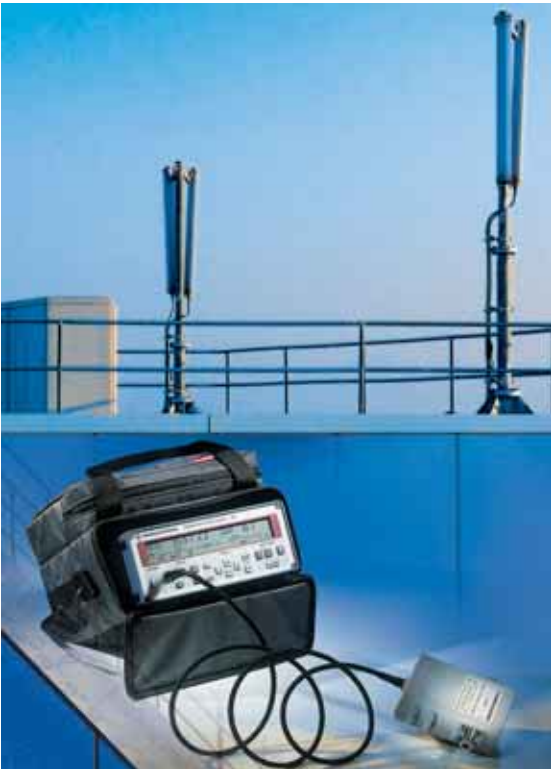
Auch für den Einsatz vor Ort ist der R&S® NRT bestens geeignet, z.B. zur Messung an GSM-Antennen
