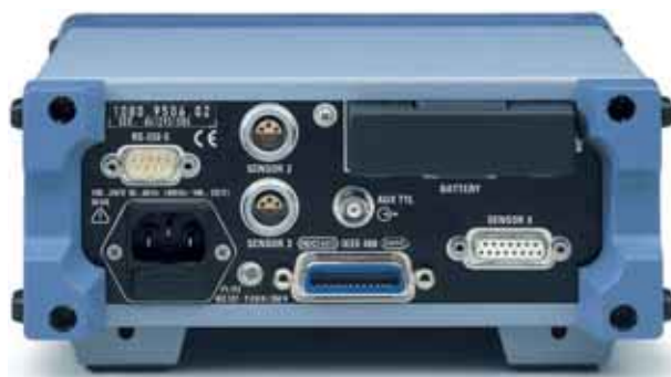
Akku, R&S® NAP-Messkopfanschluss und zwei weitere Anschlüsse für Messköpfe R&S® NRT sind über die Rückseite zugänglich
