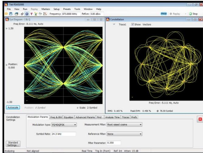
Option VM07 PDC, ( $\pi/4$  DQPSK, 21 kS/s, 800 MHz, 0 dBm), Effektivwert-EVM: 0,6 %
